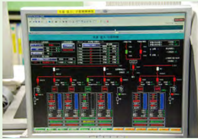
各発電機・ボイラーは総合的に制御し、効率運転を行う
